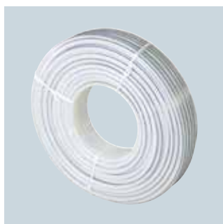
Uponor Comfort Pipe PLUS PE-Xa Rohr mit Sauerstoffdiffusionsperre aus EVOH und einer zusätzlichen äußeren Schutzschicht. Farbe weiß mit zwei blauen Streifen. Entspricht der DIN EN ISO 15875 „Kunststoff-Rohrleitungssysteme für Warm- und Kaltwassersysteme, vernetztem Polyethylen“, sauerstoffdicht nach DIN 4726.
